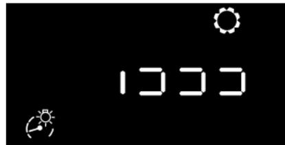
En la interfaz para ajustar el nivel de iluminación, presione el botón OK a la derecha del volante para ajustar el brillo de la luz de fondo. Hay un total de 3 niveles de brillo.
