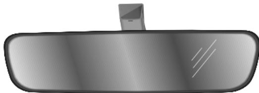
Cuando el interruptor de encendido está en la posición ON/RUN/START, se activa la función anti encandilamiento automática. Cuando los faros delanteros del siguiente vehículo pueden deslumbrar al conductor, el sensor de luz activa la función anti encandilamiento.
