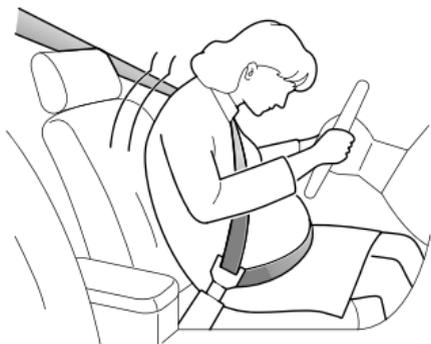
La sección diagonal del cinturón de seguridad debe pasar por el pecho de forma normal, la sección de la cadera debe pasar por debajo del abdomen, baja y ajustada a los huesos
