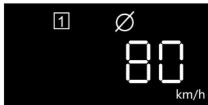
Muestra la velocidad promedio actual de conducción del vehículo. El valor se restablecerá automáticamente 1 hora después de apagarlo, o al mantener presionado el botón OK a la derecha del volante para reiniciar.
