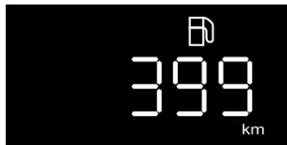
Esta función calcula y muestra automáticamente el kilometraje que el automóvil puede recorrer antes que el estanque de combustible se vacíe, y este kilometraje cambiará después de reabastecer.
