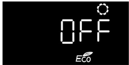
En la interfaz de configuración del modo ECO, puede presionar el botón OK a la derecha del volante para configurar el modo ECO; y presione el botón ARRIBA/ABAJO a la derecha del volante para seleccionar ON u OFF para encender/apagar el modo ECO.
