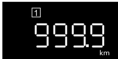
Muestra el kilometraje actual de conducción. El valor se restablecerá automáticamente después de un período en Off, o al mantener presionado el botón OK a la derecha del volante para restablecer.
