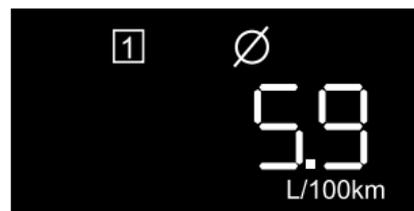
Muestra el consumo promedio de combustible en el modo actual. El valor se restablecerá automáticamente después de un período en Off, o al mantener presionado el botón OK a la derecha del volante para restablecer.
