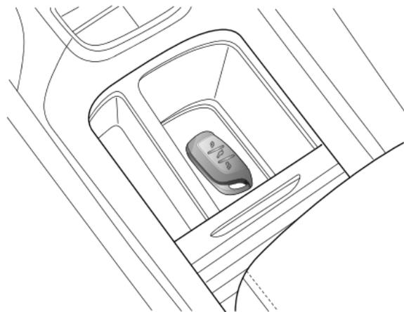
Si el automóvil está ubicado en un área donde hay fuertes señales de radio que causan interferencia o si la batería de la llave inteligente es baja, siga los siguientes pasos para intentar arrancar el automóvil:
