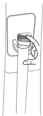
Ajuste correcto del punto de fijación del cinturón de seguridad.
