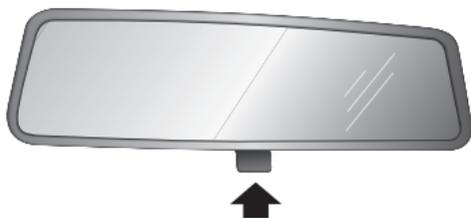
Mueva la palanca en la base del espejo hacia adelante para 'sumergirlo' y lograr la función anti encandilamiento. La visibilidad normal se restablece tirando nuevamente la palanca hacia atrás.
