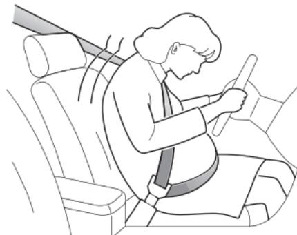
La sección diagonal del cinturón de seguridad debe pasar por el pecho de forma normal, la sección de la cadera debe pasar por debajo del abdomen, baja y ajustada a los huesos de la cadera. **NUNCA** coloque el cinturón sobre o debajo del vientre.
