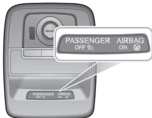
La luz de estado del Airbag del pasajero se encuentra en el aparato de la luz interior montada en el techo. La forma del ensamblaje de la luz varía según la configuración del vehículo.
